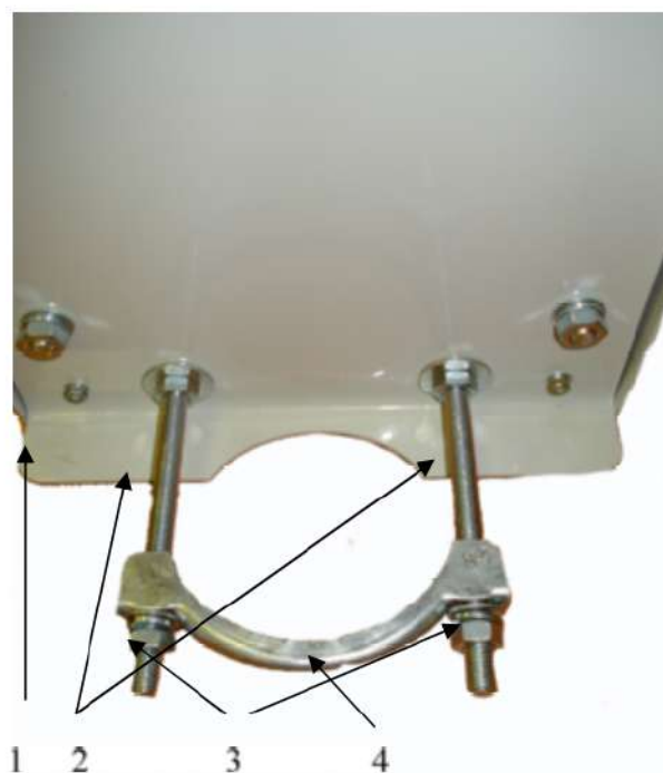
Рисунок 3 – элементы крепления БП к опоре
