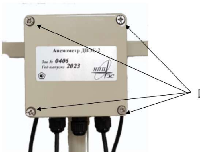
Рисунок 1 - Корпус ДВЭС с винтами крепления крышки.
